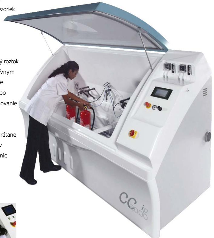
Korózna komora CCT o objeme 2000 l
