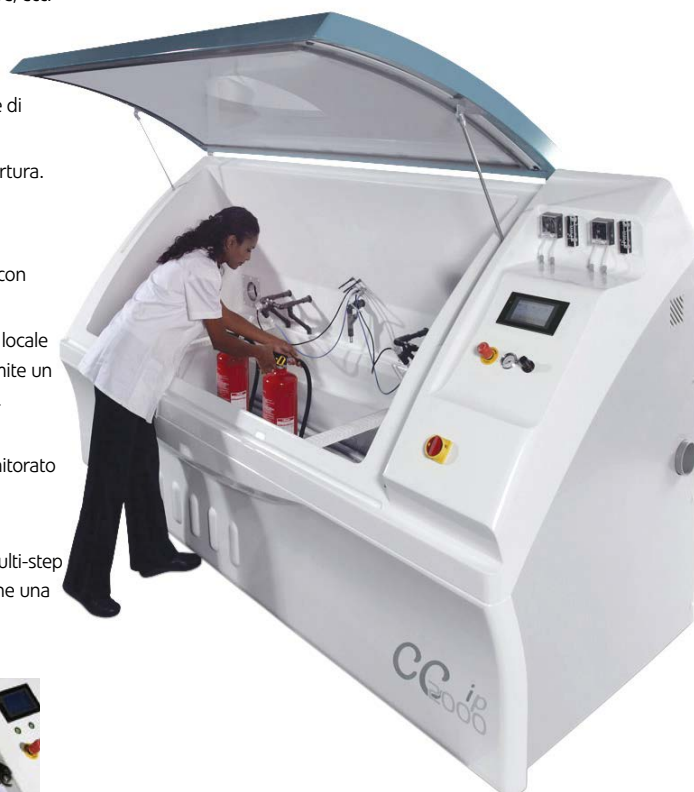
Camera CCT da 2000 litri
