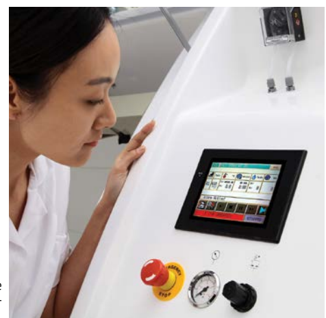
Panneau de contrôle d'une enceinte CCT
